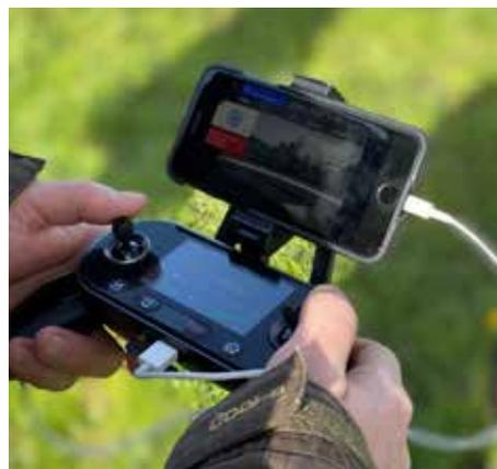
*Die Steuerung der Drohne erfolgt über das Handy gekoppelt mit einem Controlpad.*
