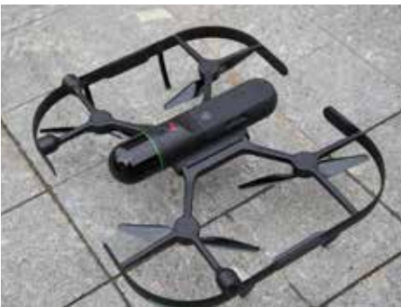
Die semi-autonome Drohne BLK2Fly
