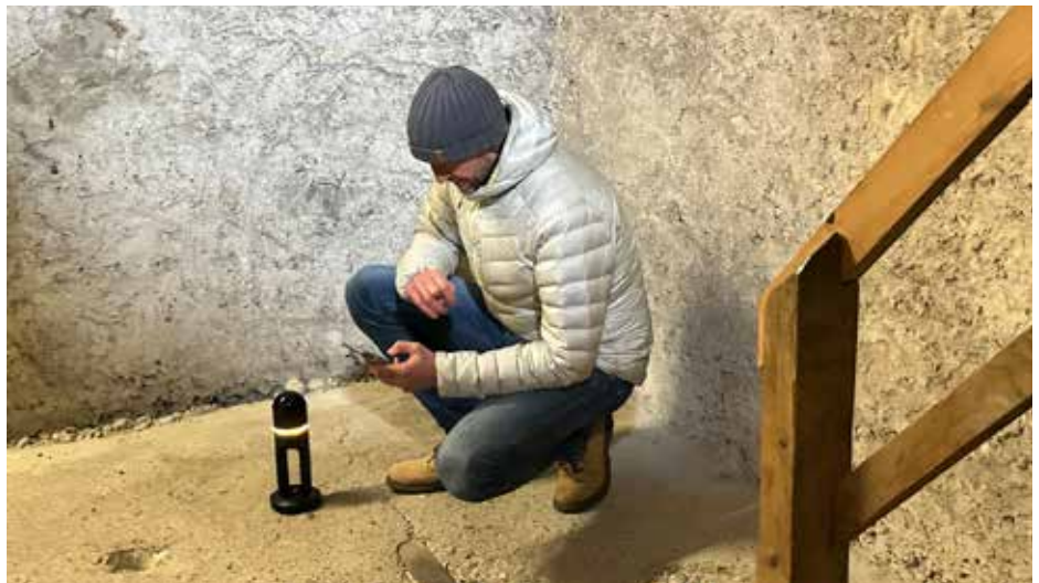
Scannen des gesamten Kirchturms mit dem Handscanner.
